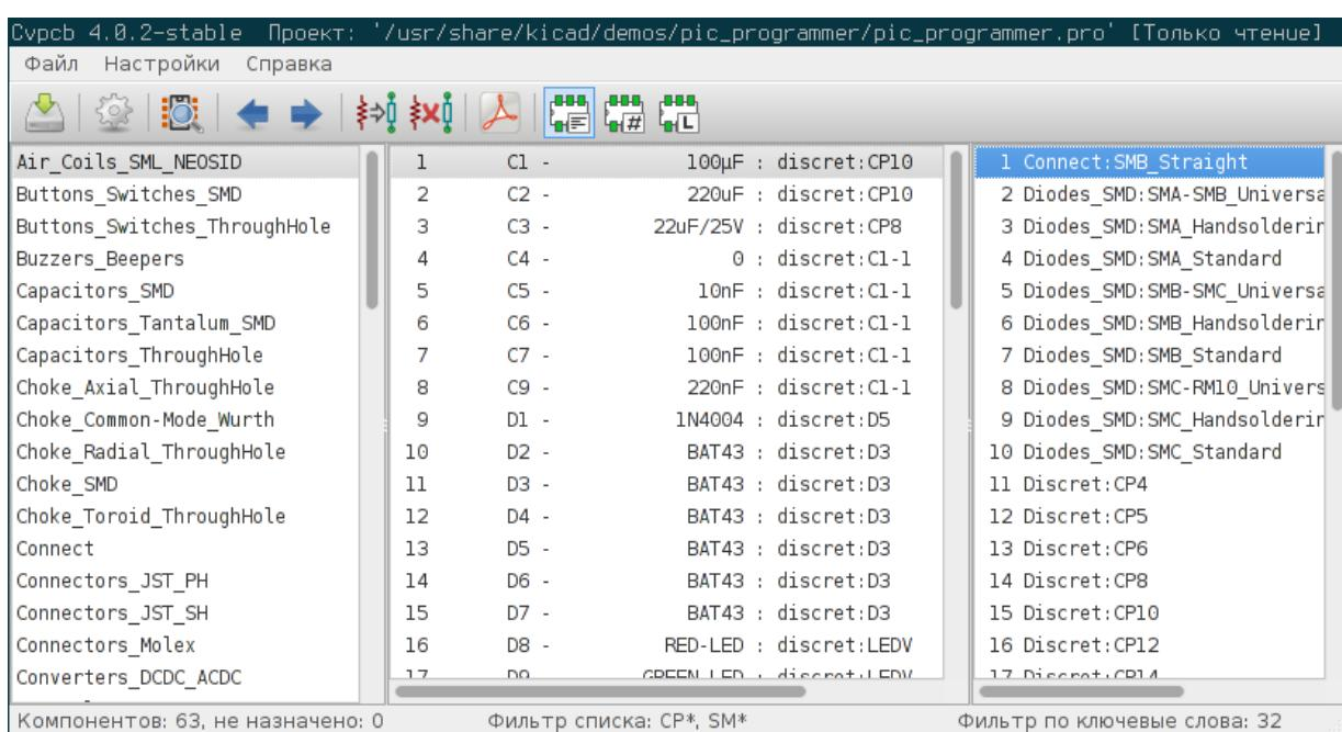
На левой панели содержится список доступных библиотек посадочных мест связанных с проектом. На центральной панели содержится перечень компонентов загруженных из файла списка цепей. Правая панель содержит список доступных посадочных мест из библиотек посадочных мест проекта. Если файл списка цепей отсутствует - перечень компонентов будет пуст, также, панель посадочных мест будет пустой, если не найдётся ни одной библиотеки.
